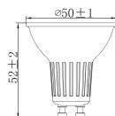
**Caractéristiques Spot LED GU10 PAR16 3W 230lm 36D - 927 | Meilleur rendu de couleur - Dimmable - Remplacement 35W**
