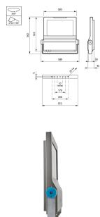
**Caractéristiques Philips Projecteur LED ClearFlood BVP650 Aluminium 95W 14240lm 140x70D - 740 | IP66 - Asymétrique**
