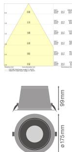
**Caractéristiques Ledvance Spot Encastrable LED Biolux DN150 21W 2200lm 60D - 927-965 Accordable Blanc | 175mm - Diamètre 160mm - Dali Dimmable - Meilleur Rendu De Couleur**
