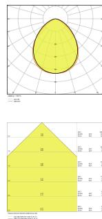
**Caractéristiques Ledvance Projecteur LED Sensor GEN 3 Noir 10W 1200lm 100D - 840 | IP65 - DéTECTEUR de mouvement et de lumière - Symétrique**
