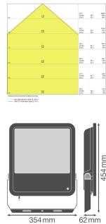
**Technische Daten Ledvance LED-Scheinwerfer Photocell GEN 3 Schwarz 200W 25000lm 100D - 840 | IP65 - Lichtsensor - Symmetrisch**
