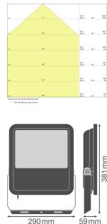
**Technische Daten Ledvance LED-Scheinwerfer GEN 3 Schwarz 125W 15000lm 100D - 840 | IP65 - Symmetrisch - Ersatz für 400W**
