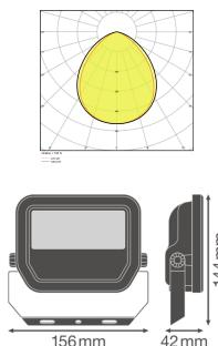
**Technische Daten Ledvance LED-Scheinwerfer GEN 3 Schwarz 20W 2400lm 100D - 840 | IP65 - Symmetrisch - Ersatz für 50W**
